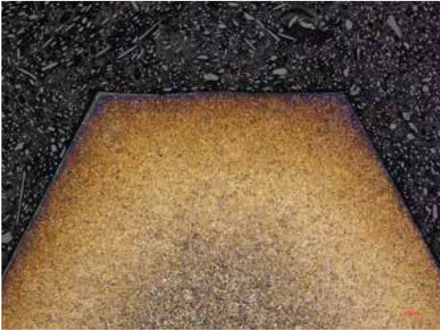
Atacado con Nital al 3%, BF (campo claro), 50x
