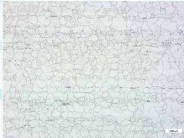
Acero Duplex, ataque electrolítico externo con ácido oxálico acuoso al 10%, 15 V, 60 - 90 sec, BF, 100x
