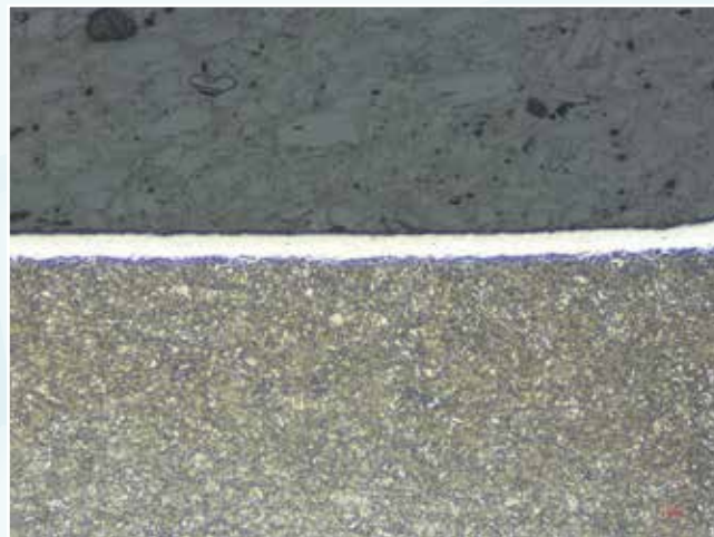
Atacado con Nital al 3%, BF (Campo claro), 200x
